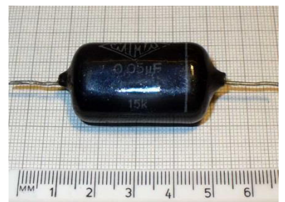
Glasröhrchen- Papier- Kondensatoren, 30er bis 60er Jahre, seitlich mit Teer vergossen, und rechts der berühmte „WIMA- Malzbonbon“ (Wiki- Bild), immer defekt- immer austauschen !
