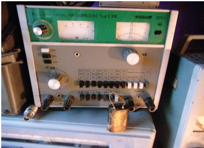
Blockkondensator 1\mu\text{F} wird mit 2\mu\text{F} angezeigt, Isolationswiderstand 4\text{M}\Omega .
