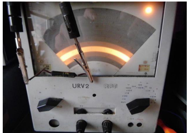
Iso-Widerstandsmessung 200pF Nr. 2 Angezeigt: ca. 400 MOhm (Soll: > 4GOhm)
