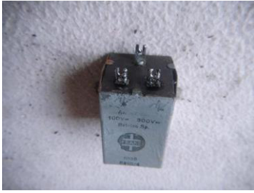
Blockkondensator, 1938, im Radio (Schirmgitterkondensator), unbrauchbar
