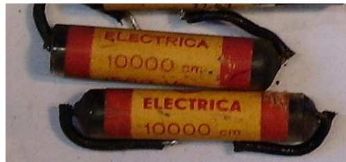
Glasröhrchen- Papier- Kondensatoren, 30er bis 60er Jahre,, seitlich mit Teer vergossen, immer defekt, immer austauschen !
