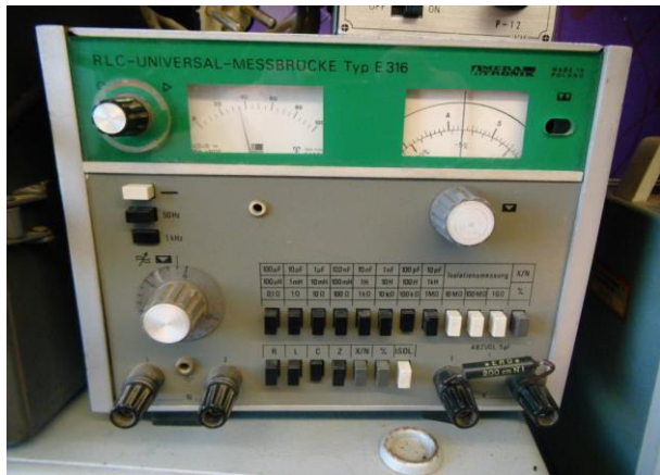
Kapazitätsmessung 200pF Nr. 2 aus Tiefpaß Angezeigt: 425pF !
