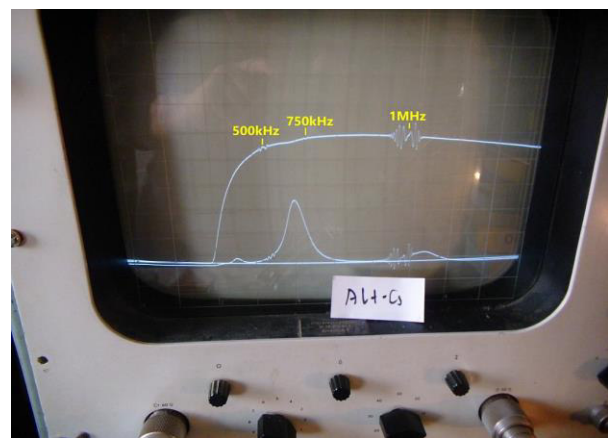
Durchlaßkurve Tiefpaß Alt- Cs Nur noch halbe Ausgangsspannung, Dämpfung 10dB !
