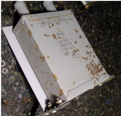
Blockkondensatoren, DDR, 60er und 70er Jahre, immer noch in Betrieb, in Gleichstrom-Stromversorgungsbaugruppen von Meßgeräten, u. a. dem hier verwendeten Wobbelsichtgerät.
