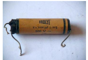
Glasröhrchen- Papier- Kondensatoren, 30er bis 60er Jahre,, seitlich mit Teer vergossen, immer defekt, immer austauschen !
