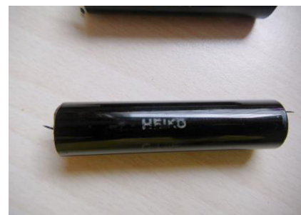
Glasröhrchen- Papier- Kondensatoren, 30er bis 60er Jahre, seitlich mit Teer vergossen, und rechts der berühmte „WIMA- Malzbonbon“ (Wiki- Bild), immer defekt- immer austauschen !
