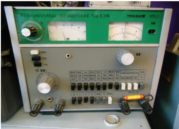
Kapazitätsmessung 100pF aus Tiefpaß Angezeigt: 320pF
