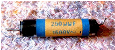
Glasröhrchen- Papier- Kondensatoren, 30er bis 60er Jahre,, seitlich mit Teer vergossen, immer defekt, immer austauschen !
