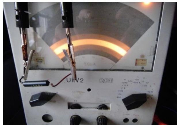
Iso-Widerstandsmessung 200pF Nr. Angezeigt: ca. 400 MOhm (Soll: > 4GOhm)
