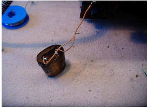
Kondensator- Wickel aus dem Blockkondensator- Blechkästchen, für die Messung neu bedrahtet
