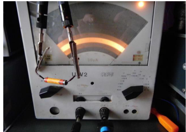
Iso- Widerstandsmessung 100pF aus Tiefpaß Angezeigt: ca. 300 MOhm (Soll: > 4GOhm)
