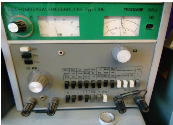
Kapazitätsmessung 200pF Nr. 1 aus Tiefpaß Angezeigt: 385pF
