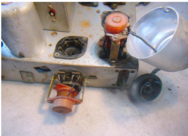
Das ZF- Filter an der Seitenwand ist der Anodenkreis
