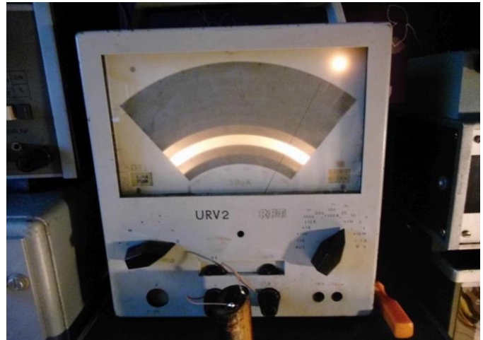
Blockkondensator 1\mu\text{F} wird mit 2\mu\text{F} angezeigt, Isolationswiderstand 4\text{M}\Omega .
