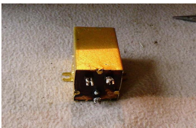
Blockkondensator im Blechgehäuse, neu befüllt. Innen Seitenwände aus Hartpappe, die Original-Einleger aus Pertinax gingen beim Öffnen kaputt.
