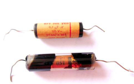
Glasröhrchen- Papier- Kondensatoren, 30er bis 60er Jahre, seitlich mit Teer vergossen, und rechts der berühmte „WIMA- Malzbonbon“ (Wiki- Bild), immer defekt- immer austauschen !
