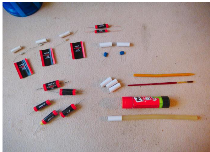
Anfertigung von Papierröllchen für die Kondensatoren über Bleistift oder Heißkleber- Stift
