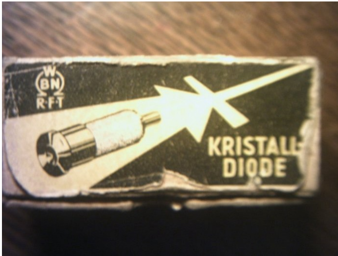
Die Spitzendiode des HF- Eingangs in einer Messing- Keramik- Patrone.
