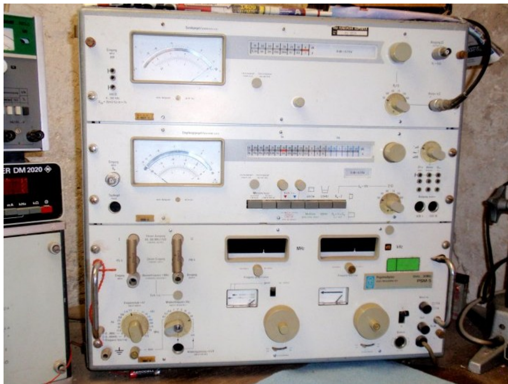
„Fremdmarken- Lieferant“ Wandel & Goltermann Pegelmessplatz (Bj. 1964), volltransistorisiert (Germanium- Technik), Bereich 0- 30 MHz, er enthält Generator und Messempfänger. Hier vertragen sich ost- und westdeutsche Technik hervorragend.
