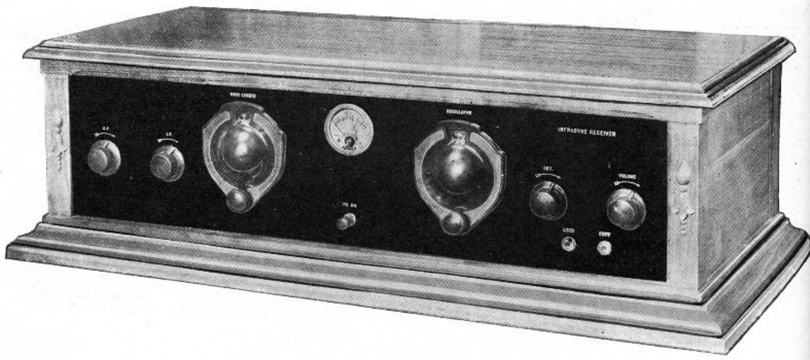
Die dritte Ausführung des "Infradyne", 1926, aus dem "Citizens Radio Callbook", 1926-09, es enthält Kammererspulen
